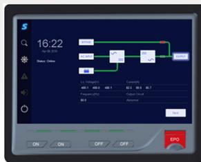
Pantalla táctil a color con osciloscopio integrado de 4 canales para solucionar problemas de entrada, salida y señal de CC sin necesidad de utilizar software especial o herramientas encriptadas. Permite el análisis de voltaje trifásico, corriente, frecuencia, voltaje de enlace de CC y corriente de CC dentro del chasis del UPS.
